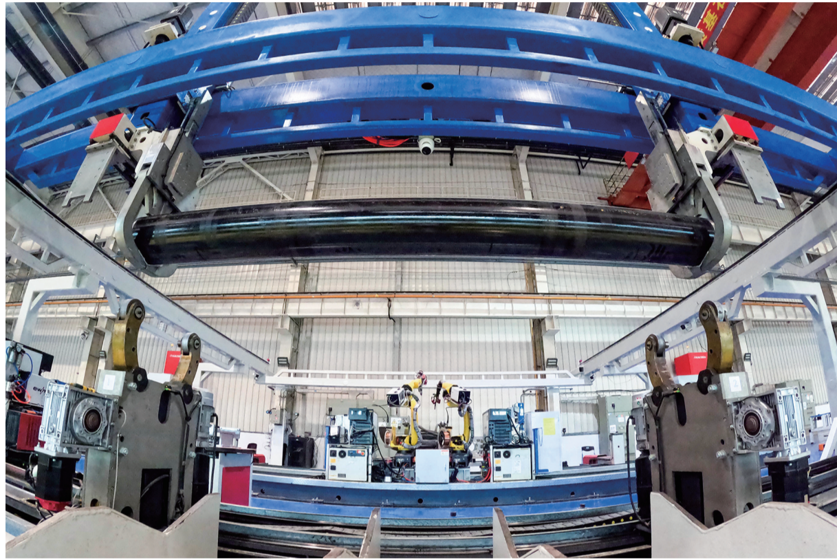
这是5月10日拍摄的海油工程珠海深水装备制造基地深水油气装备工艺管线智能生产线。海洋石油工程股份有限公司5月10日发布消息，我国首条深水油气装备工艺管线智能生产线在海油工程珠海深水装备制造基地建设完成，进入调试阶段。
