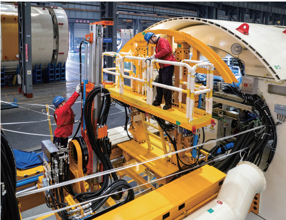
12月18日，工人在铁建重工长沙第二产业园调试“中国有色二号”掘进机（无人机照片）。当日，由铁建重工和中国十五冶金建设集团联合打造的“中国有色二号”掘进机在长沙下线，该设备开挖直径为5.63米，长约130米，重约800吨，将参与赞比亚矿山工程隧道建设。
