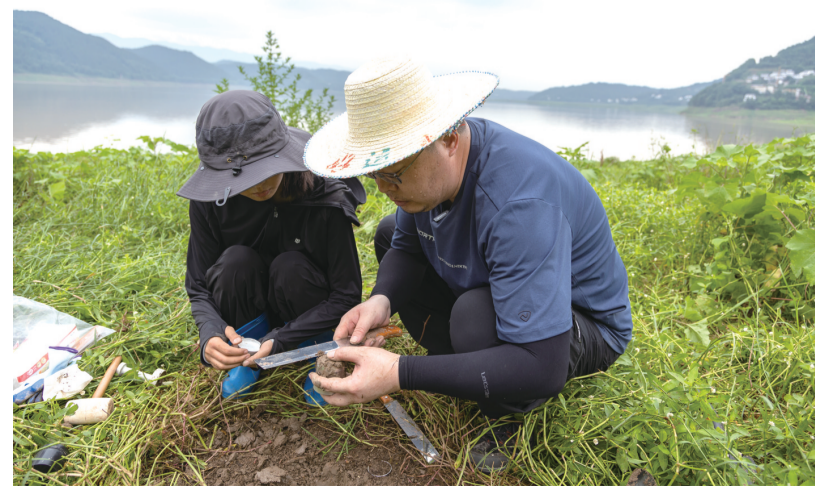
在重庆市忠县，中国科学院成都山地所副研究员鲍玉海（右）带领团队在三峡水库消落带采集土壤环刀样品（7月6日摄）。新华社记者 黄伟 摄
