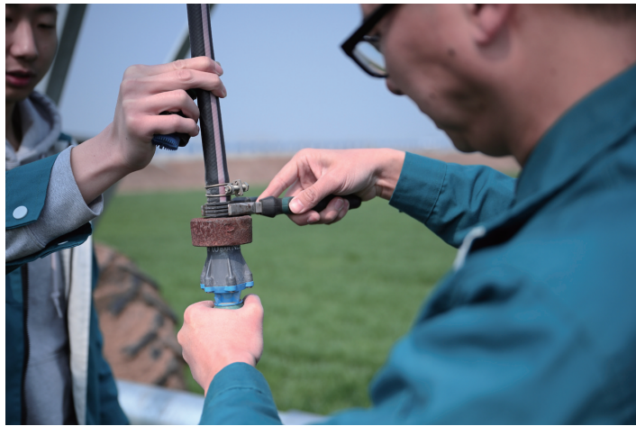
2月28日，在西平县老王坡高标准农田示范区，刘亚辉（右）和王英凡在更换喷灌机的喷头。
