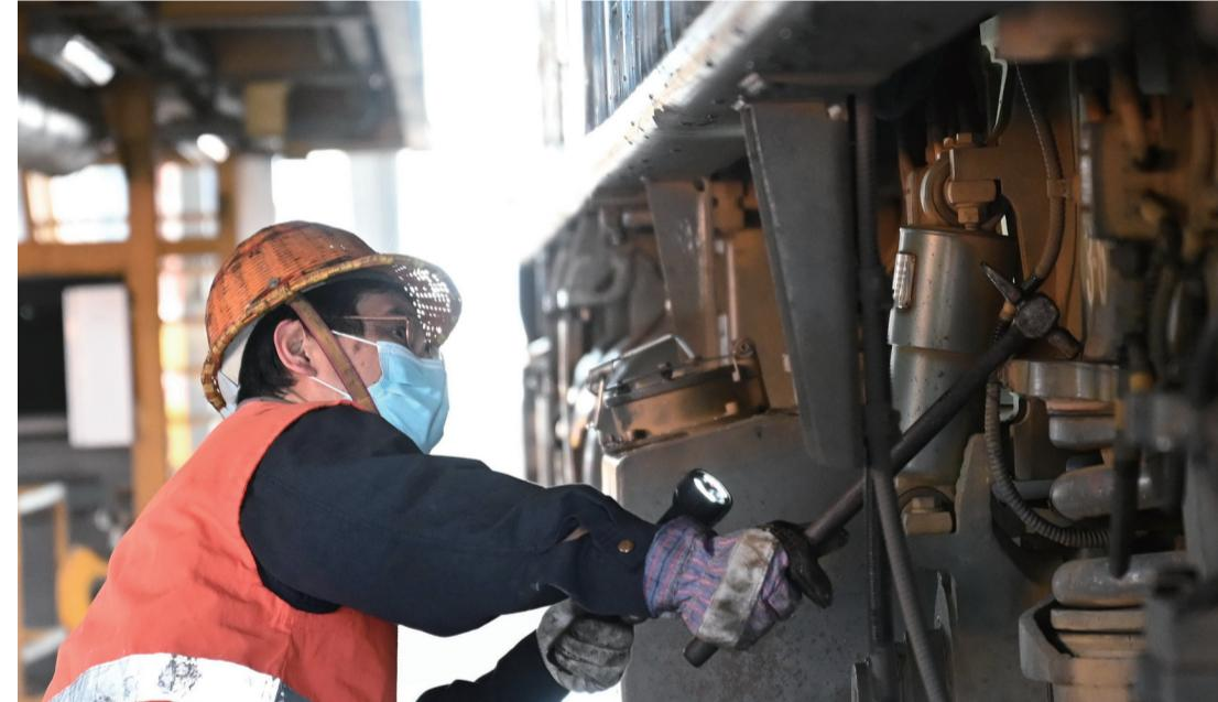
2月14日，工人余深忠在福州机务段福州整备车间对和谐号机车部件进行检查。春节期间，在福建福州的重点工程建设现场和企业车间，仍有许多劳动者坚守岗位，在工作中度过佳节。
