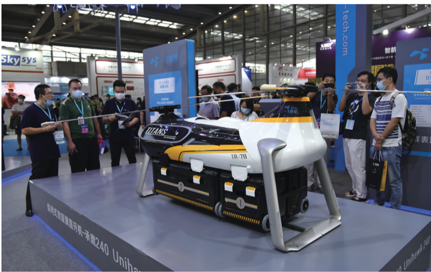
9月13日在第四届世界无人机大会现场拍摄的一款最大载重240kg的纵列式双旋翼无人机。
