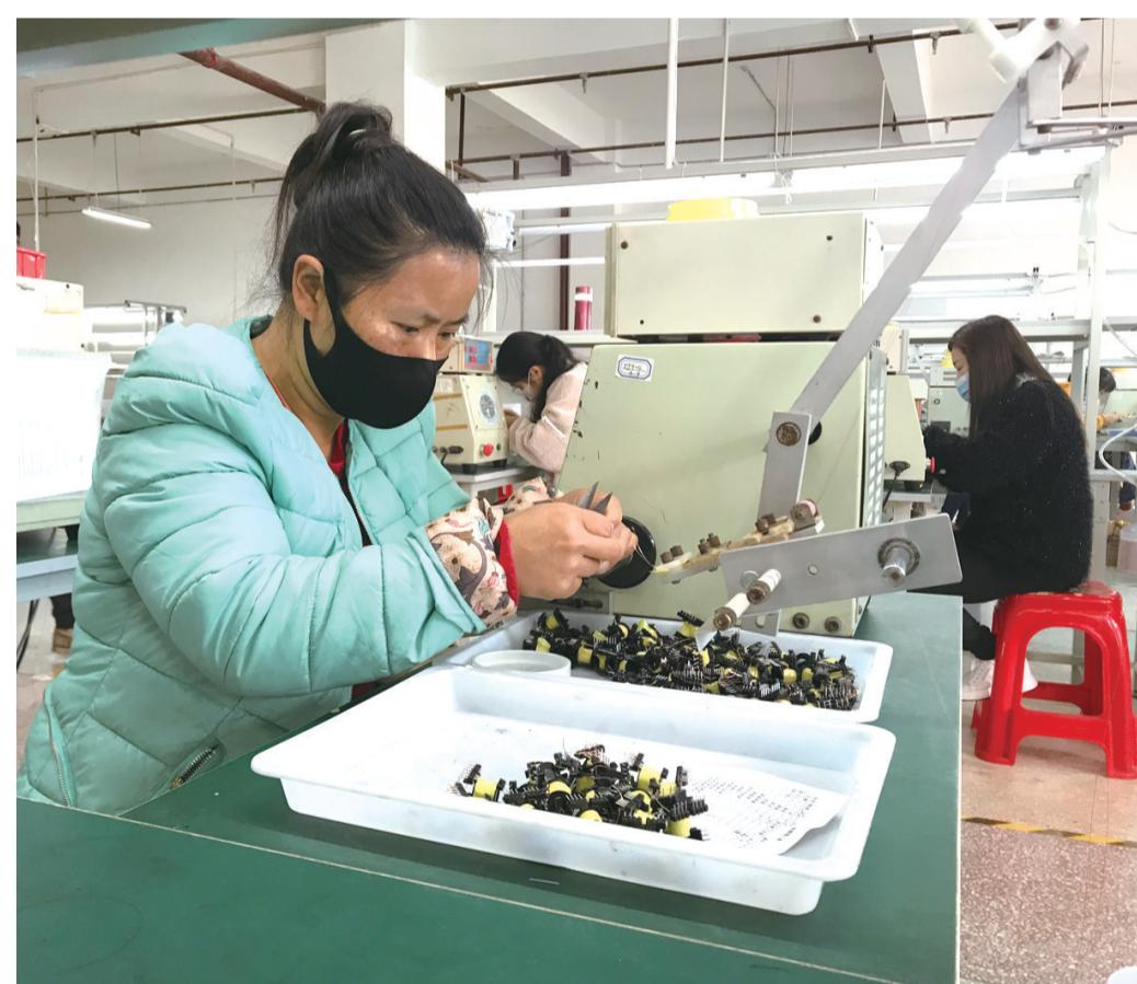
4月10日，桑植县工业园张家界峰亚电子有限公司工人正在制作电子变压器零配件。该公司复工复产以来，抓紧生产，力争把疫情造成的损失减少到最低程度。
