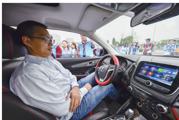
▲2019 年 5 月 15 日，在重庆仙桃数据谷进行的 5G 远程驾驶试验汽车城市道路行驶演示现场，测试人员在车内演示通过 5G 远程驾驶系统，远程操控汽车方向盘。 新华社记者 刘源 摄
