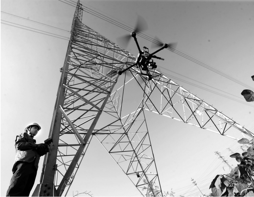
8月8日，工作人员在对自主巡线无人机进行监控测试。无人机可以实现从机巢自主起飞、巡线并降落，同时用5G网络实时传送高清数据图像、飞行控制信号，实现数传和图传合一。 当日，浙江省宁波供电公司在宁波杭州湾新区建成人机协同智能巡检示范区，并成功通过无人机及巡线机器人自主巡线输电线路运行测试。 新华社记者 徐昱 摄
